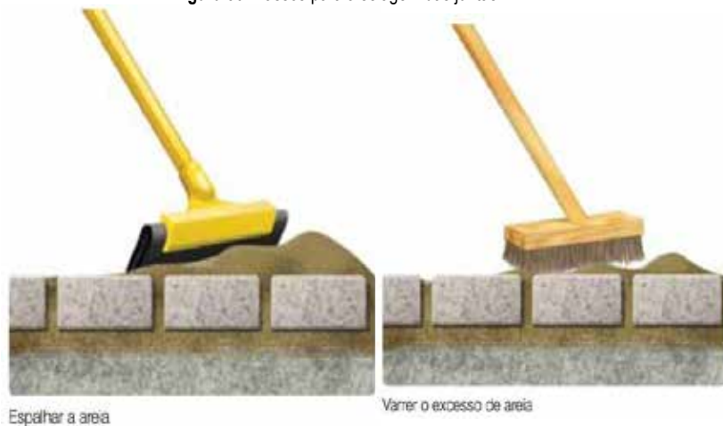
Figura 90: Passos para a selagem das juntas
