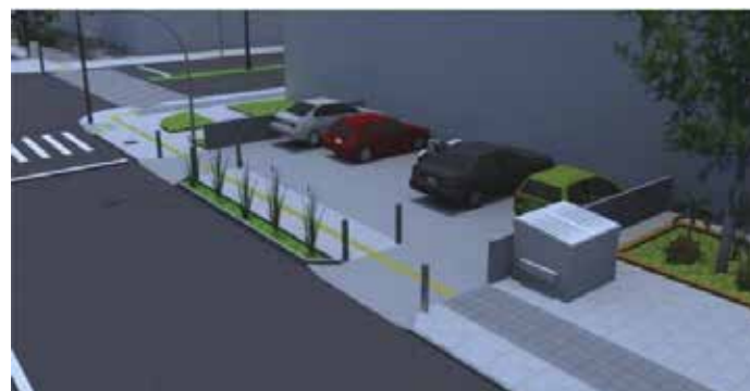
Figuras 13 e 14: Imagem e planta baixa da calçada com rebaixo de meio fio para veículos.
