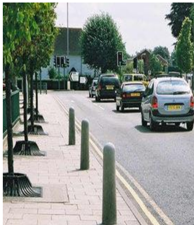
Figura 55: Exemplo de pilarete como divisor de fluxo
