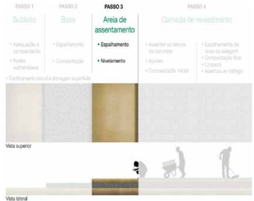
Figura 77: Detalhe da areia de assentamento
