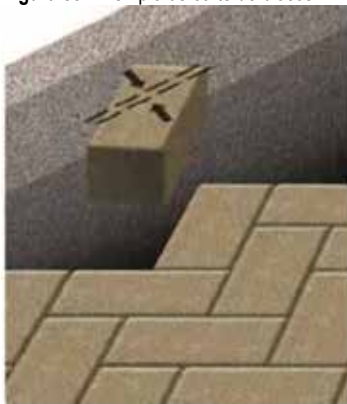
Figura 85: Exemplo de corte de blocos
