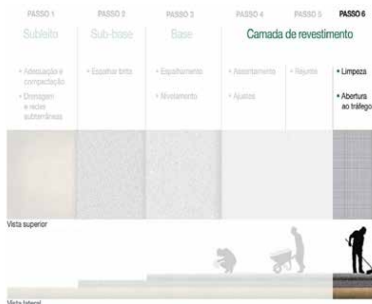
Figura 105: Camada de revestimento - limpeza e abertura ao tráfego
