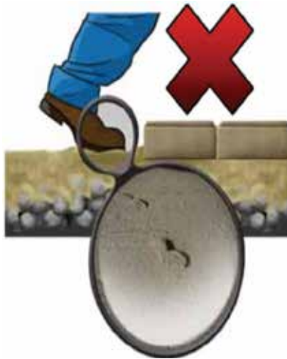
Figura 80: Detalhe da areia com o alerta para não pisar depois de pronta
