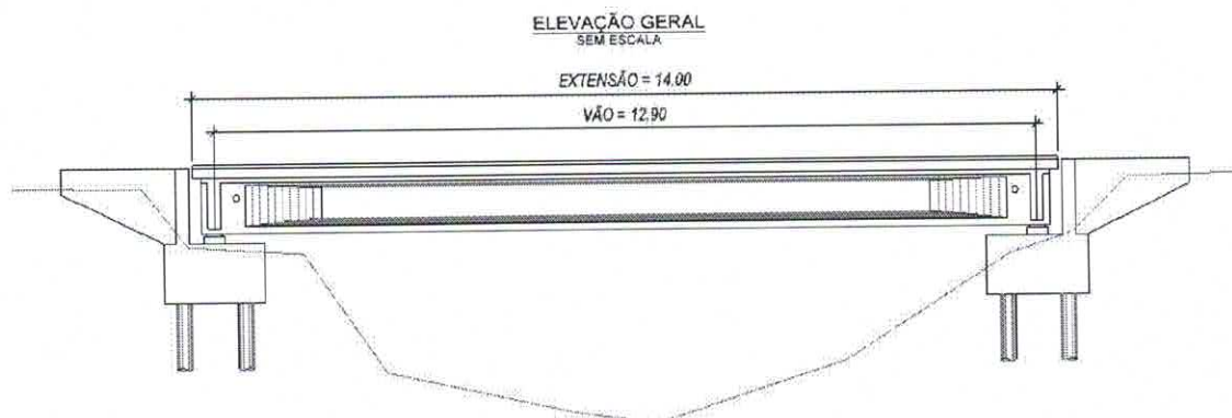
Figura 06: Diferença entre extensão e vão
